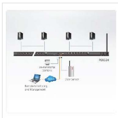
**La gamme NRGence d'ATEN est une nouvelle génération d'unités de distribution d'énergie verte (eco PDU) qui optimisent l'efficacité de l'utilisation de l'énergie dans les centres de données. Les eco PDU PE8324 sont des PDU intelligents qui comportent 24 prises CA et sont disponibles dans diverses configurations de prises**
