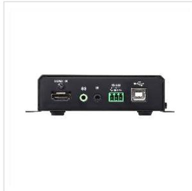
L'émetteur vidéo sur IP ATEN VE8900T délivre des signaux AV 1080p visuellement sans perte avec une faible latence sur longue distance via un réseau Gigabit standard.
