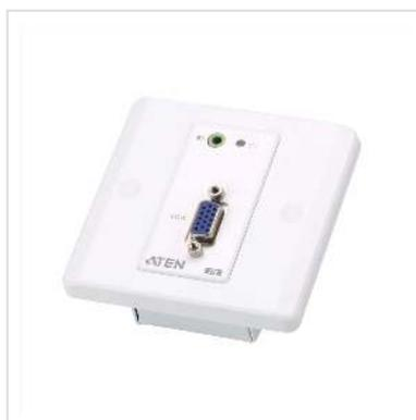
Le système d'extension Cat 5 VGA/audio avec plaque murale MK VE157 est conçu pour être monté dans une boîte de jonction unique. Il étend les signaux audio et VGA jusqu'à 150 mètres sur un câble Cat 5e/6 et prend en charge les formats d'écran large tout en assurant une excellente qualité vidéo.
