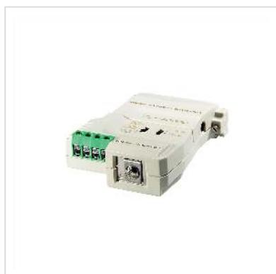
**IC485SI est un convertisseur bidirectionnel pour convertir des signaux RS-232 vers et depuis des signaux RS-422/RS-485 dans des applications longue distance jusqu'à 1200 m. Il comprend une languette de mise à la terre pour une isolation améliorée du signal et de l'alimentation.**
