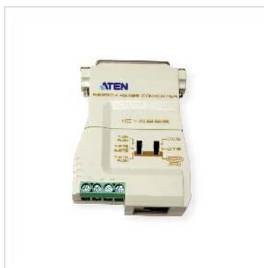
**IC485S est un convertisseur bidirectionnel pour convertir des signaux RS-232 vers et depuis des signaux RS-422/RS-485 dans des applications longue distance jusqu'à 1200 m. Il prend en charge la connexion d'un maximum de 32 hubs et la surveillance des fonctions pour confirmer les données passant entre les périphériques.**
