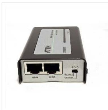
Le système d'extension USB HDMI VE803 vous permet d'augmenter la distance de transmission des signaux HDMI jusqu'à 60 mètres de la source HDMI, en utilisant deux câbles de catégorie 5e. Il est en mesure d'envoyer des signaux 1080i jusqu'à 60 mètres et des signaux 1080p jusqu'à 40 mètres.
