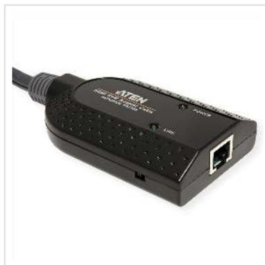
Câble adaptateur KVM HDMI USB avec prise en charge des supports virtuels et lecteur de carte à puce (Module CPU)
