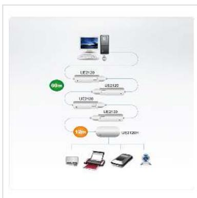
Le concentrateur UE2120H est un concentrateur d'extension actif qui permet d'augmenter la distance qui sépare un ordinateur d'un ou plusieurs périphériques USB jusqu'à 12 mètres. Les signaux USB transmis par le biais de ces câbles conservent une intégrité optimale et sont conformes aux standards USB 2.0. Il est possible de connecter en chaîne jusqu'à 4 câbles d'extension (UE2120) et 1 concentrateur d'extension (UE2120H), de sorte que la distance peut être étendue jusqu'à 60 mètres.
