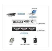
Le Hub avec convertisseur USB vers interfaces sérielles RS-232 de ATEN offre à un ordinateur ou Notebook équipé d'une interface USB une connexion externe sérielle Plug-and-Play. C'est la solution rapide, simple et de peu de coût pour les applications de communication et d'automatisation.
