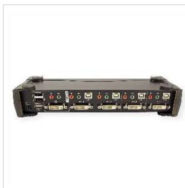
**Le commutateur KVMP™ DVI Dual Link USB CS1784A représente une véritable révolution dans le monde des commutateurs KVM. Il combine les capacités d'un commutateur KVM à 4 ports avec un concentrateur USB à 2 ports, tout en offrant une interface de moniteur DVI et la prise en charge du son.**
