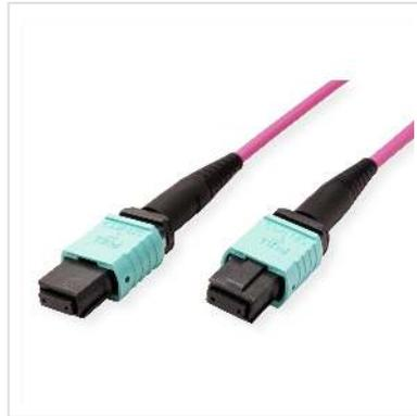
**Câble Trunk, utilisé comme liaison permanente entre les modules MPO. Le câble trunk a 12 fibres, il est équipé des deux côtés par un connecteur MPO 12 fibres.**
