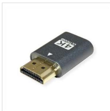
**L'émulateur EDID est connecté à la sortie de la carte graphique et relié à l'écran désiré. La connexion avec l'écran étant coupée, la carte graphique ne le remarque pas, elle conserve les paramètres sélectionnés (résolution, fréquence). En reconnectant l'écran à nouveau, on obtient directement l'image optimale. Ceci est particulièrement important lors de l'utilisation de switches KVM.**
