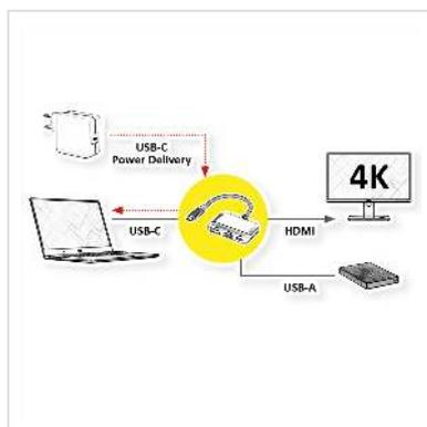
**Connectez votre Macbook, ultrabook, notebook/ ou PC avec interface USB type C à un écran HDMI ou un projecteur - avec une résolution maximale de jusqu'à 3840x2160 @30Hz ! Rechargez simultanément votre appareil via PD (Power Delivery) et connectez un périphérique supplémentaire ou un autre appareil comme un SSD au port USB type A supplémentaire.**
