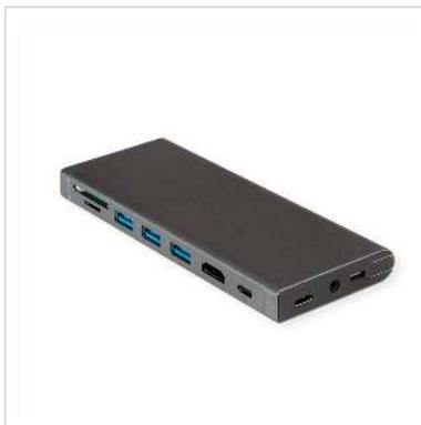
**Connectez votre MacBook, ultrabook, notebook/portable via USB type C à un réseau local ainsi qu'à des périphériques fixes - un écran HDMI par exemple - et via les différents ports USB à un clavier ou à des disques durs externes par exemple, tout en rechargeant simultanément votre appareil via le port USB type C PD. Il est également possible de lire des cartes SD ou TF.**
