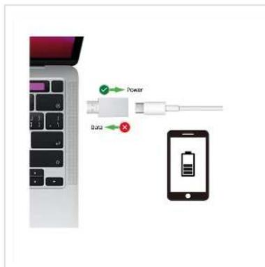
**Le protecteur de données USB type A (M) vers USB type C (F) annule les voies de données du port USB utilisé et protège ainsi votre appareil contre les accès indésirables ou les logiciels malveillants - il ne transmet rien d'autre que de l'énergie. Cette solution est particulièrement utile dans les lieux publics où les prises USB peuvent être manipulées ou détournées relativement facilement, tels que par exemple les hôtels ou les aéroports ou gares.**
