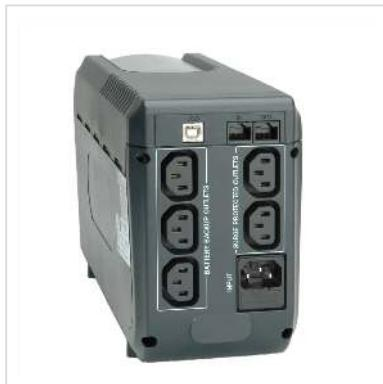
**L'onduleur ROLINE DesignSecure de technique Line Interactive est prévu pour une utilisation avec les postes de travail. Le réglage de la différence entre la tension d'entrée réelle et celle nécessaire se fait par "Buck and Boost". L'administration des batteries permet de les surveiller et de les recharger uniquement si nécessaire. Cela permet un prolongement de leur temps de vie de 50%.**
