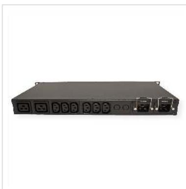
**Le commutateur de transfert automatique (ATS) est un dispositif à haute disponibilité conçu pour fournir une alimentation redondante aux équipements électroniques sensibles. Alimenté par deux sources d'alimentation indépendantes, il passe rapidement d'une source à l'autre automatiquement, lorsque l'alimentation utilisée pour alimenter sa charge connectée tombe en panne.**
