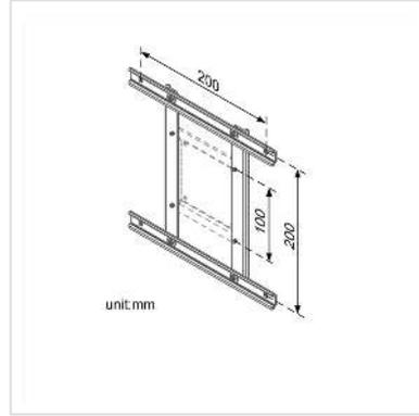
**ROLINE adaptateur VESA dans des dimensions variables de 100 x 100 jusqu'à 200 x 200, pour la fixation d'un téléviseur ou écran au mur ou à un bras pour écran — compatible avec des écrans de différentes tailles de diagonale.**
