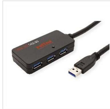
**Le hub pratique avec son câble de connexion USB de 10 m de long permet de connecter jusqu'à quatre périphériques USB à une plus grande distance du PC. L'utilisateur est ainsi pratiquement indépendant de l'emplacement des appareils à connecter (par ex. imprimante). L'alimentation électrique est fournie par le PC via l'interface USB, mais un bloc d'alimentation (5VDC, 3,5A) peut également être connecté en option.**
