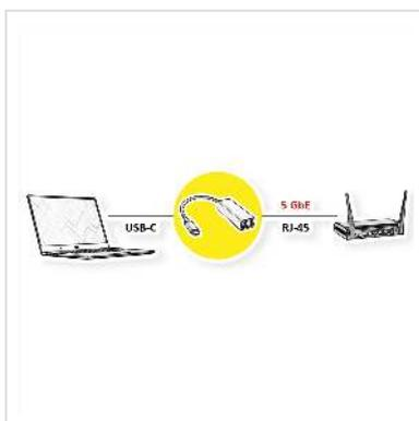
**Avec ce convertisseur, vous pouvez connecter votre PC ou ordinateur portable avec interface USB de type C à un réseau avec jusqu'à 5 Gigabit Ethernet.**
