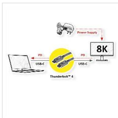
**Les câbles Thunderbolt 4 avec le connecteur USB 3.1 de type C vous offrent le taux de transfert de données actuellement le plus élevé possible jusqu'à 40Gbit/s et la prise en charge complète de la puissance (PD jusqu'à 20V 5A / 100W) ! Les câbles sont également équipés du mode DP pour la transmission d'images et de sons jusqu'à 7680x4320 @60Hz (8K).**
