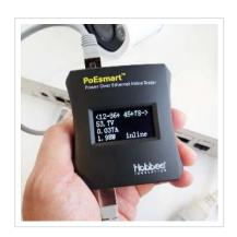
Le détecteur HOBBES PoEz est un détecteur / testeur PoE Power-over-Ethernet qui peut être utilisé pour un PSE (Power Source Equipment), pour détecter l'état de l'alimentation lors de l'installation d'un système PoE ou pour un système de vidéosurveillance.
