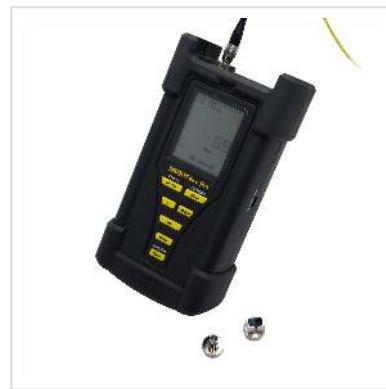
**Le SMARTFiberPro est un appareil de mesure de puissance fibre optique facile à utiliser pour tester la force de la transmission de la lumière dans les fibres optiques sur six longueurs d'onde: 850, 1300, 1310, 1490, 1550 et 1625 nm. L'appareil teste l'intensité de la lumière à fibre optique dans une plage de +3 à -60 dBm.**
