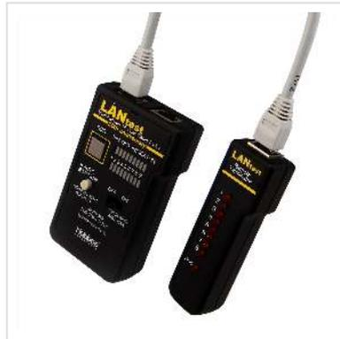
**Le Hobbes LANtest RJ45 Basic Network Cable Tester est l'un des dispositifs de cartographie des câbles de réseau les plus simples et les moins chers du marché. Utilisez-le pour déterminer la configuration de câblage réelle des câbles téléphoniques Cat5, coaxiaux et modulaires. Les défauts de câblage tels que les fils ouverts, les courts-circuits, les paires de fils mal câblés et croisés peuvent être clairement identifiés.**
