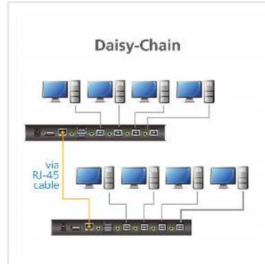
**Der CS724KM ist ein 4-Port USB KM Switch, mit dem Benutzer bis zu 4 Computer mit einer einzigen Tastatur und Maus steuern können. Zwei Switches können in Daisy-Chain werden, um die Steuerung von bis zu 8 Computern von einer einzigen Konsole aus zu ermöglichen.**
