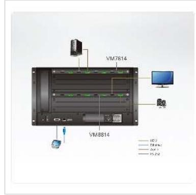
**Die VM7814 ist eine 4K HDMI-Eingabekarte, die mit einem ATEN Modular Matrix Switch arbeitet und eine einfache Möglichkeit bietet, 4 HDMI-Quellen auf 4 Displays zu routen. Zusätzlich zur HDMI-Schnittstelle, die digitale A/V-Signale überträgt, verfügt die VM7814 über 4 Stereo-Audioeingänge, die eine Stereo-Audioeinbettung ermöglichen.**
