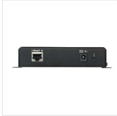
**Der ATEN VE816R 4K HDMI HDBaseT Empfänger mit Scaler wurde entwickelt, um mit mehreren ATEN HDBaseT Matrix Switches zu arbeiten, um 4K HDMI Signale bis zu 100 m über ein einzelnes Cat 5e/6/6a oder ein ATEN 2L-2910 Cat 6 Kabel zu verlängern und gleichzeitig Videos mit unterschiedlichen Auflösungen für eine optimale Darstellung zu skalieren.**
