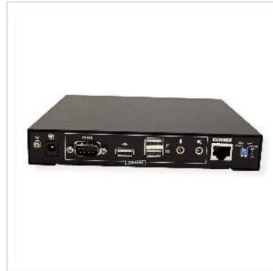
**Der ATEN CE624 USB DVI HDBaseT™ 2.0 KVM Extender verfügt über die neuesten HDBaseT™ 2.0 Technologien für die zuverlässigste Übertragung von Video, Audio, USB und RS-232 Signalen, die auf dem Markt verfügbar ist.**
