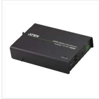
**Der VE882 ist eine HDMI-Verlängerung, die dank Glasfaserübertragung die traditionelle Grenze von Kabellängen für die Übermittlung von HD-Bild und Ton bei weitem überschreitet.**
