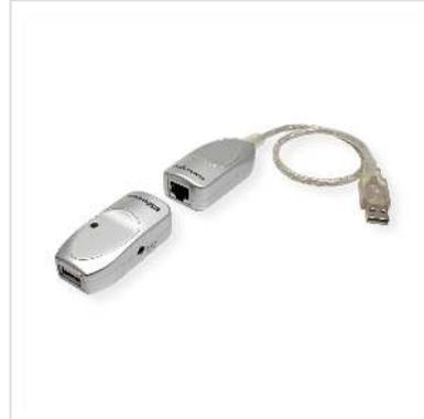
**USB 1.1 Verlängerung Over Kat.5e / Kat.6 (bis zu 60 m). Mit dem UCE60 können Sie Ihr USB-Peripheriegerät oder USB-Hub bis zu 60m entfernt vom Computer aufstellen und umgehen so die typische Einschränkung der maximalen USB-Kabellänge.**
