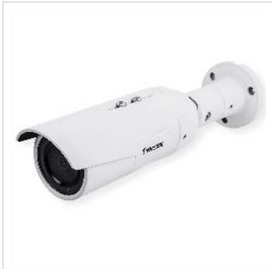
**Die IB9389-Serie von VIVOTEK ist eine H.265 Bullet-Netzwerkkamera, die mit einem 5-Megapixel-Sensor ausgestattet ist und eine Auflösung von 2560x1920 bei 30 FPS ermöglicht, Ausgestattet mit VIVOTEK SNV und WDR Pro Technologie, IR-Strahler Reichweite 30 Meter, IP66- und IK10-Gehäuse, Smart Stream III-Technologie, H.265-Codec-Unterstützung, VIVOTEKs VADP (VIVOTEK Application Development Platform)**
