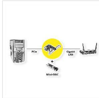
**Dieser PCIe 1G SFP-Netzwerkadapter ist eine kostengünstige Lösung, die einen schnellen und zuverlässigen 1-Gbit/s-Netzwerkzugang über größere Entfernungen Netzwerke bietet. Mit einem kompatiblen SFP-Transceiver können Sie Ihren PCIe-basierten Server oder Ihre Workstation direkt an Ihr 1G-Netzwerk anschließen.**
