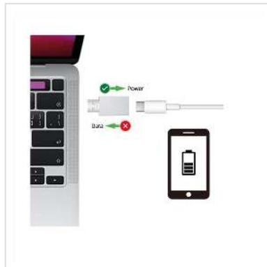
**Der USB Typ A (ST) nach C (BU) Datenblockier-Adapter stoppt die Datenleitungen des verwendeten USB-Anschlusses aus und schützt so Ihr mobiles Endgerät, wie z.B. Ihr Smartphone, vor ungewolltem Zugriff oder vor Schadsoftware, da nur Strom übertragen werden kann. Das ist vor allem sinnvoll in fremden Umgebungen, in denen vergleichsweise leicht USB-Buchsen manipuliert oder gekapert werden können, wie in Hotels, Flughäfen oder Bahnhöfen.**
