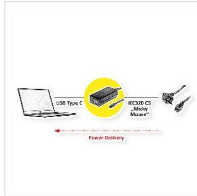
**Perfekt für unterwegs zum Aufladen oder als Spannungsversorgung von USB-C Geräten weltweit. Einfach Stromkabel mit C5 Kupplung und länderspezifischem Anschluss in den C6 Stecker des USB-Ladegerätes stecken.**
