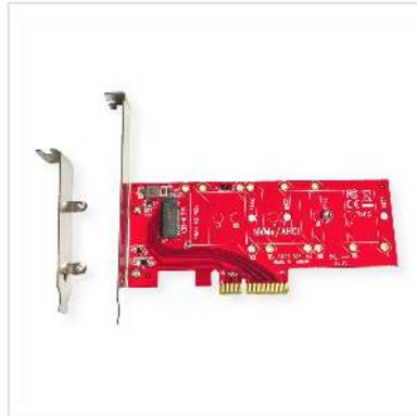
**Neuer NVMe-Standard (basiert auf PCI Express 4.0 mit 4 Lanes) ermöglicht es die Datengeschwindigkeit gegenüber einer normalen SATA-SSD nochmals zu erhöhen. Die Konsequenz: Mehr Bandbreite und reduzierte Latenzzeiten gegenüber der SATA Schnittstelle.**
