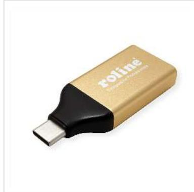
**Schließen Sie an Ihr MacBook, Ultrabook, Notebook/Laptop, PC oder an ein mobiles Gerät mit USB Typ C Anschluss einen TV, einen Monitor oder Projektor mittels HDMI an - bei Auflösungen von bis zu 3840x2160 @60Hz!**
