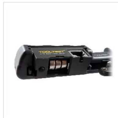
**Der Tooltest ist ein kleines handliches Kabeltestgerät. Es ermöglicht dem Netzwerk Profi auf schnelle und einfache Weise die angeschlossenen Ethernet Doppelkabel Pin für Pin auf die Kontinuität der Verdrahtung und auf die gängigsten Fehler wie Kurzschluss, offene Adernpaare, falsche Verdrahtungen zu überprüfen.**
