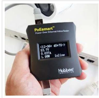
**Der HOBBS PoE-Detektor PoEsmart ist ein Inline-Power-over-Ethernet-Tester, ein unverzichtbares Gerät für den Betrieb eines PoE-Systems.**
