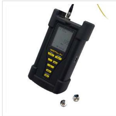
**Der SMARTFiberPro ist ein einfach zu handhabendes LWL-Leistungsmessgerät zum Testen der Stärke der Lichtübertragung in fiberoptischen Fasern über sechs Wellenlängen: 850, 1300, 1310, 1490, 1550 und 1625 nm. Das Gerät testet die fiberoptische Lichtstärke in einer Bandbreite von +3 bis -60 dBm.**
