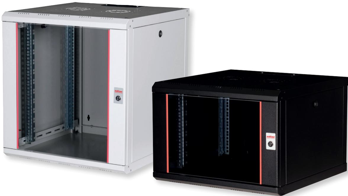
Die Wandgehäuse der ROLINE Pro Serie wurden speziell für eine flexible Netzwerkverkabelung konzipiert. Jeder Schrank verfügt über einen aufschiebbaeren Kabel-einlass im Dach mit Moosgummidichtung. Die robusten Stahlkonstruktionen der Schränke bestehen aus bis zu 1,5 mm starkem Stahlblech.
