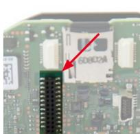
Drücken Sie die Platine des Moduls vorsichtig mit einem Finger auf den Steckplatz. Stellen Sie sicher, dass das Mx-A-IOA-IC vollständig eingesteckt ist.
