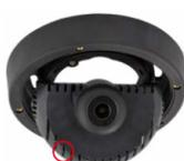
Die LED blinkt jetzt ein Mal und wiederholt dieses Blinksignal nach einer Pause von einer Sekunde (die Anzahl der Blinksignale entspricht der aktuell auswählbaren Boot-Option). Drücken Sie die Taste erneut kurz (< 1 s), um zur nächsten Boot-Option zu wechseln. Nach der letzten Boot-Option wird wieder die erste angezeigt (1 x blinken).
