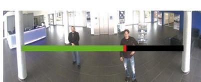
Drehen Sie das Objektiv mit dem roten Objektivschlüssel vorsichtig hin und her, bis der rote Bereich der im Kamerabild eingeblendeten Scharfstellhilfe möglichst vollständig verschwunden ist.
