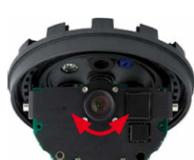
**Remarque :** Le dôme induit un effet de lentille qui modifie légèrement le point de réglage de la netteté du téléobjectif B237. Tournez le téléobjectif (avant le montage du dôme) de **90° environ dans le sens inverse des aiguilles d'une montre** (contre la direction de vissage de l'objectif). Une fois le dôme monté, contrôlez la netteté de l'image et corrigez-la le cas échéant.
