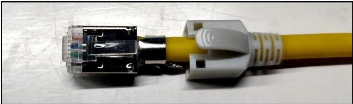
11. Enfiler la douille D sur le connecteur A.
