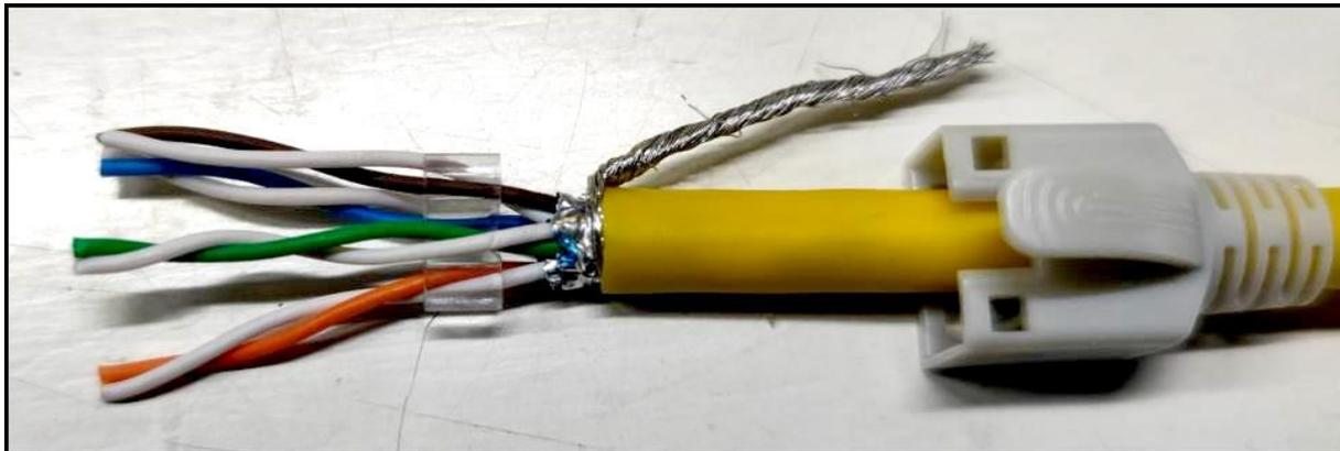
4. Introduire chaque paire de câbles dans les 4 rainures du guide C (ne pas défaire la torsade) (paires orange et paires marron dans 2 des rainures à gauche et à droite) paires vertes et paires bleues dans les 2 rainures supérieures et inférieures)
