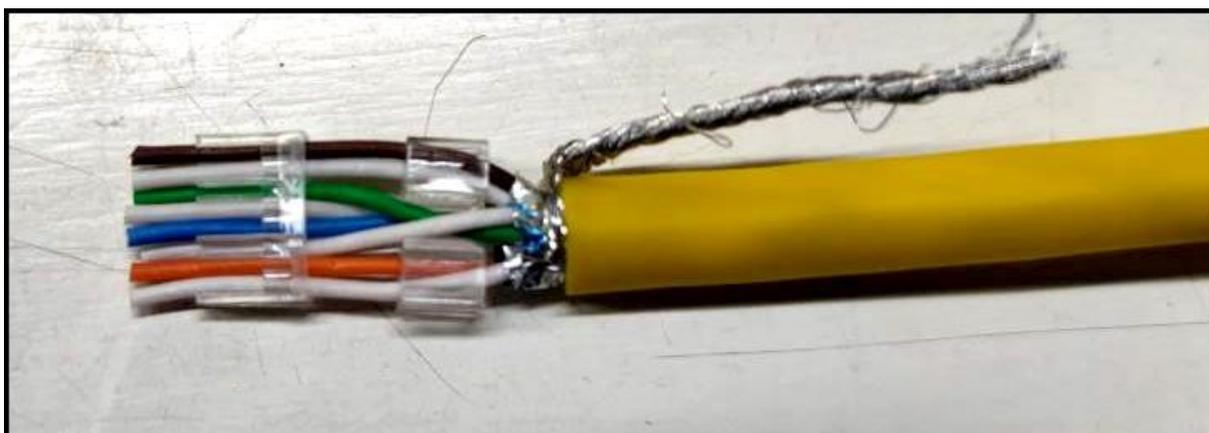
5. Placer les conducteurs dans le guide-câble B conformément à l'affectation T568B ou T568A.
