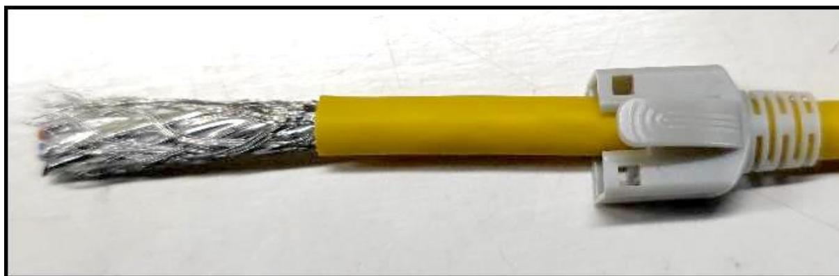
2. Faire passer le câble dans la douille D, dénuder la gaine extérieure du câble brut sur environ 30 mm.
