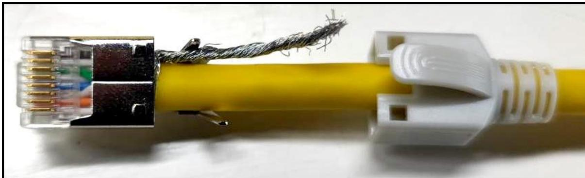
7. Introduire le câble avec les deux guides B et C dans le connecteur A.
