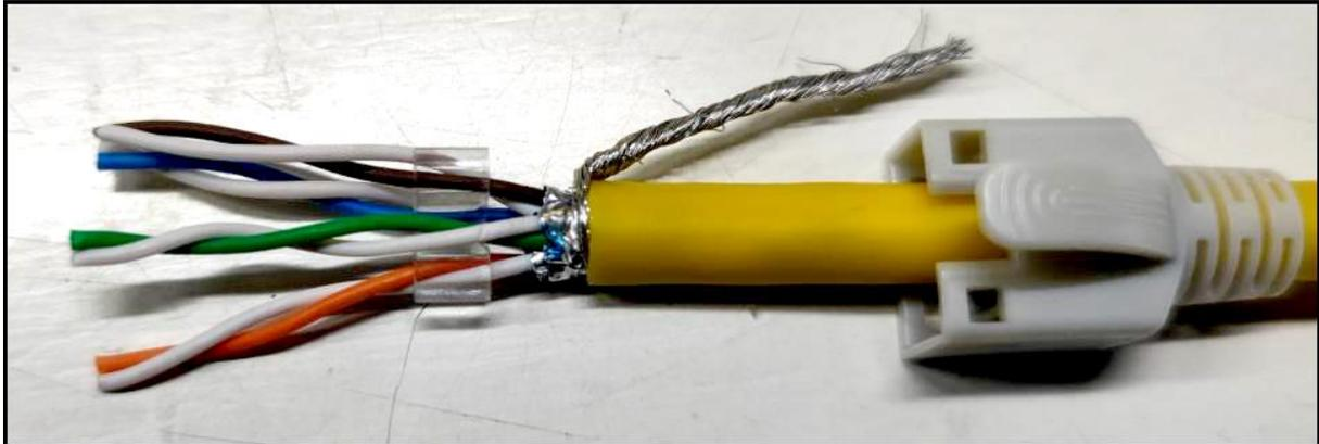
4. Jedes Kabelpaar in die 4 Nuten der Führung C einführen (nicht die Verdrillung auflösen)
