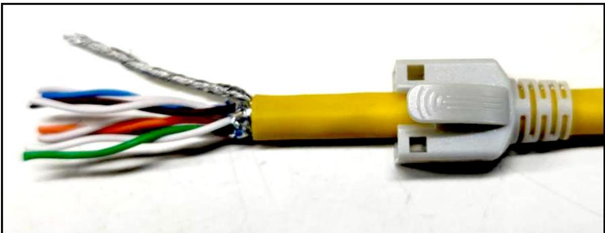
3. Das Geflecht zum Einzeldraht verdrillen und die AL-Folie abisolieren.
