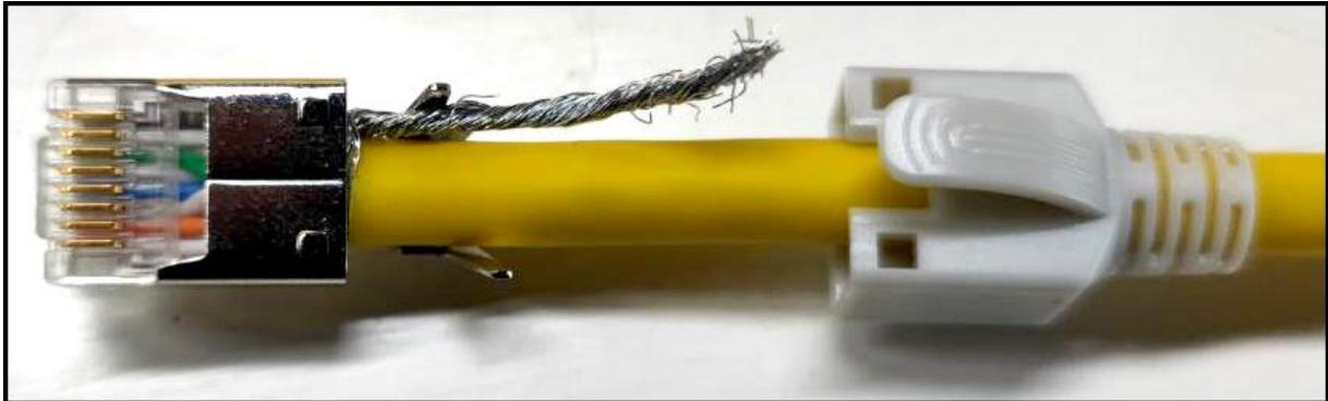
7. Das Kabel mit beiden Führungen B und C in den Stecker A einführen.
