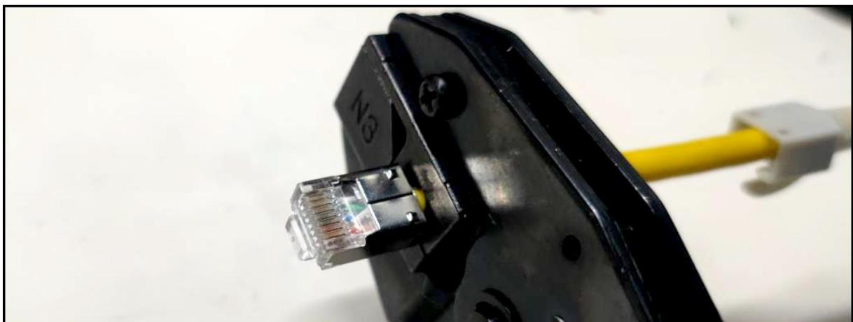
9. Mit Zangen-Werkzeug die Schwalbenschwanzklemme zu pressen.
