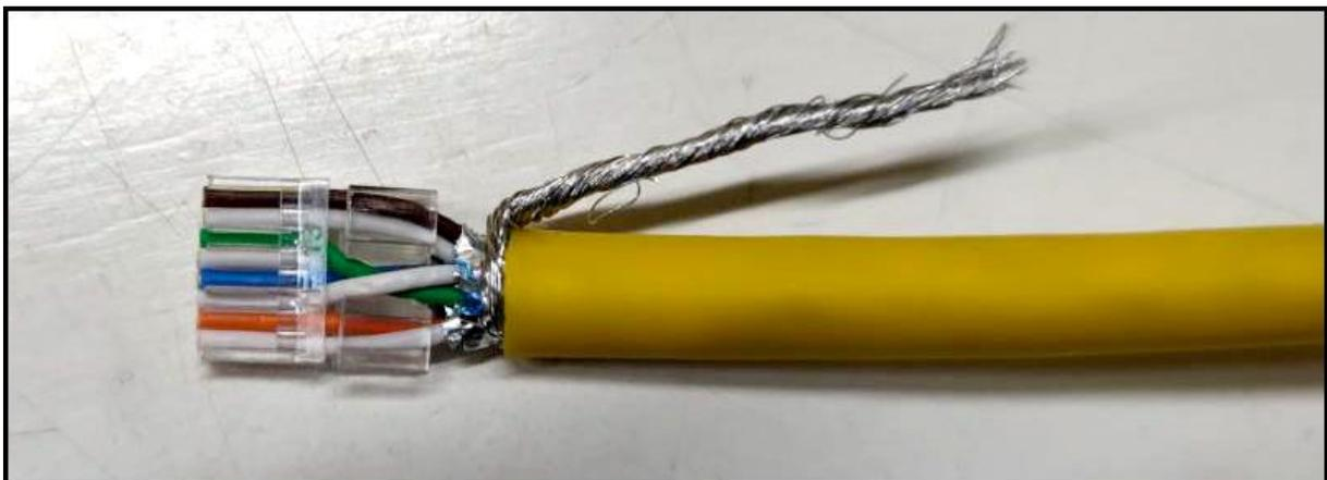
6. Das Kabel in der Führung B bis zum Ende schieben, den überstehenden Draht abschneiden (hier ist Belegung nach T568B erfolgt).
