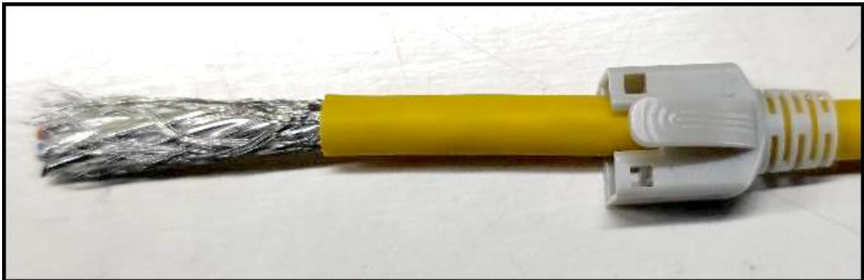
2. Kabel durch die Hülse D führen, den äußeren Mantel des Rohkabels ca. 30mm abisolieren.
