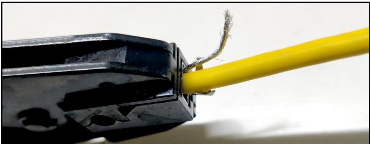
8. Den Stecker A mit der Crimpzange crimpen.
