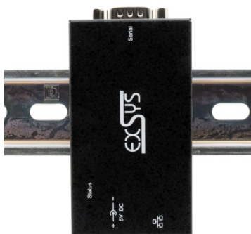
Montage an Tragschiene
