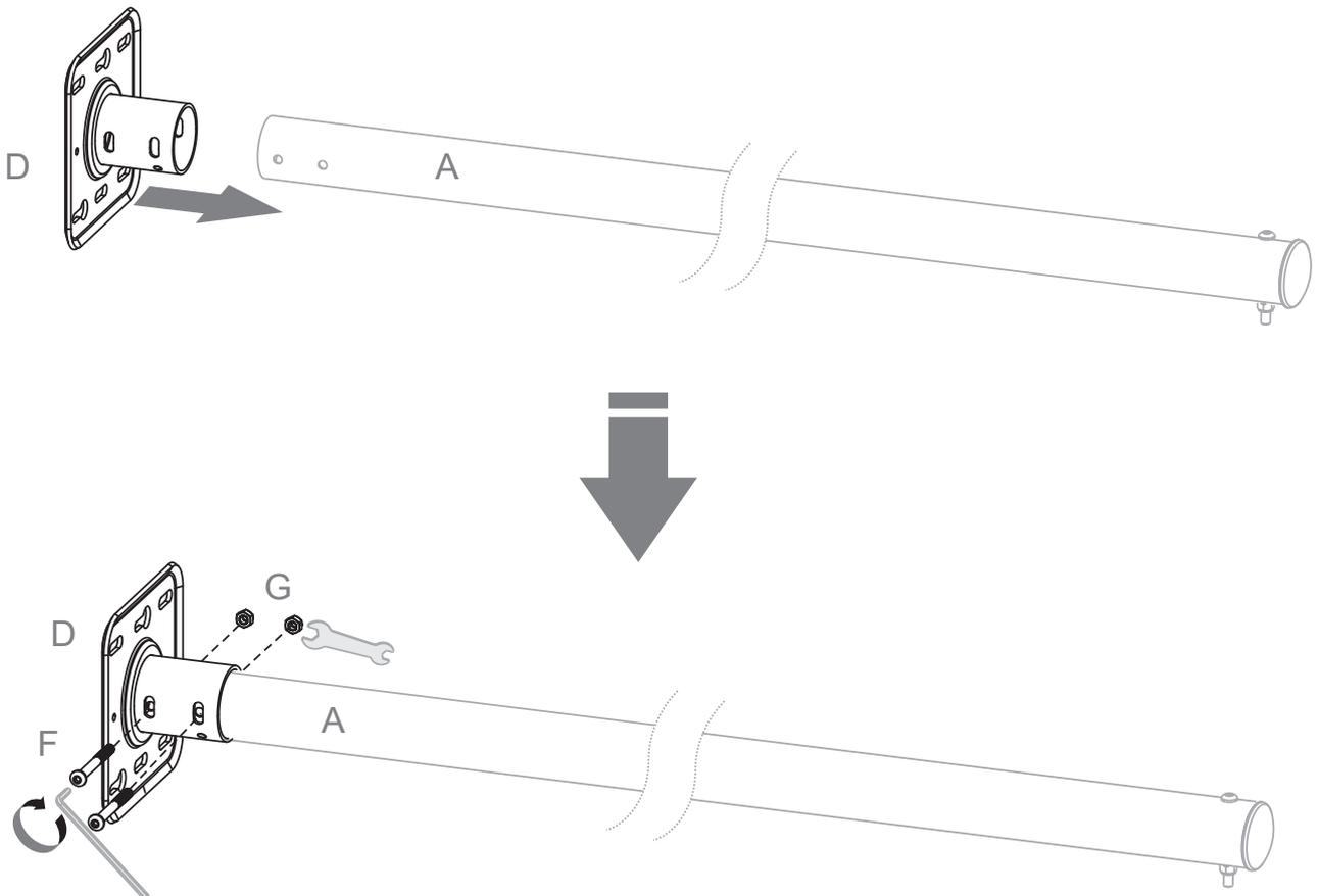
**7 Einheit montieren (Boden / Decke) | Mount unit (floor / ceiling)**
