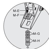
· Verwenden Sie für den Bildschirmtyp geeignete Schrauben, Unterlegscheiben und falls nötig Distanzscheiben.
