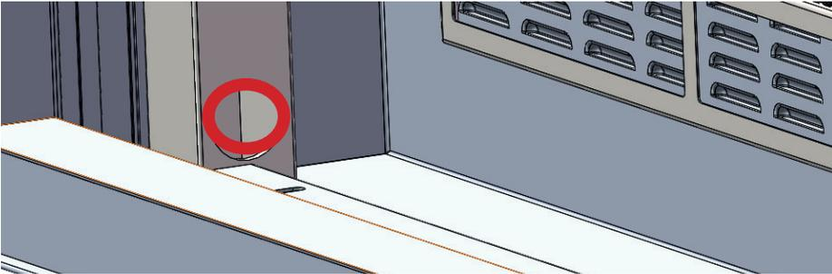
Führen Sie die benötigten Kabel durch einen oder Beide Pfosten in das Innere der Stele.
