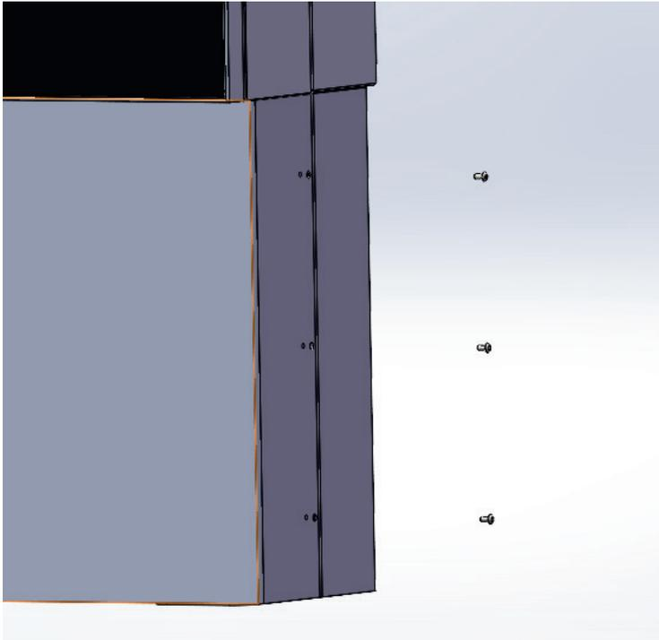
Entfernen Sie die seitlichen Schrauben der unteren Verblendung auf beiden Seiten.
