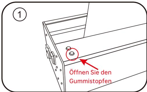
Öffnen Sie den Gummistopfen unten der linken Seite der Abdeckung
