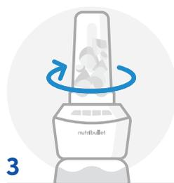
Retournez complètement le gobelet et placez-le sur la base à moteur, tournez doucement dans le sens des aiguilles d'une montre pour le fixer.
