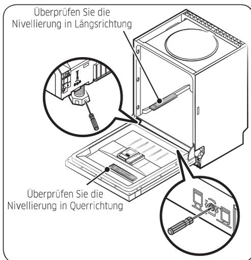
Sie können die Höhe der Spülmaschine so einstellen, dass sie waagrecht steht. Bei diesem Arbeitsschritt darf die Spülmaschine nur zur Hälfte in den Einbauschränk geschoben sein.
