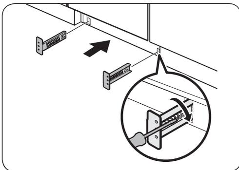
3. Schieben Sie die Trittblende mit den Halterungen unten in die Spülmaschine hinein (siehe Abbildung).
