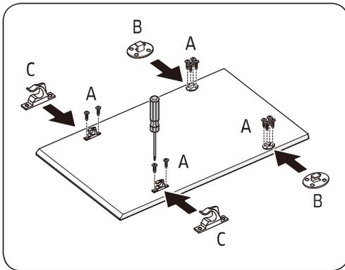
3. Entfernen Sie die Einbauschablone , und befestigen Sie die Halterungen (B) und (C) dann wie in der Abbildung gezeigt mit 12 Schrauben (A).
