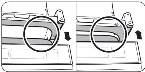
4. Lassen Sie mindestens 5 mm Abstand zwischen der Oberseite der Spülmaschine und der Unterseite der Arbeitsplatte.
