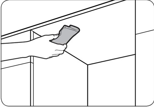
1. Reinigen Sie die Unterseite der Arbeitsplatte.
