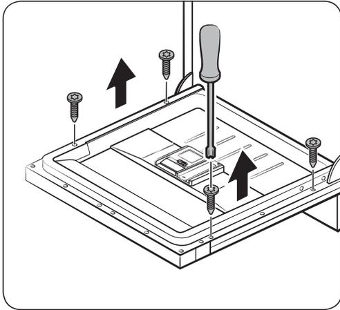
9. Öffnen Sie die Gerätetür, und entfernen Sie die 4 Schrauben.
