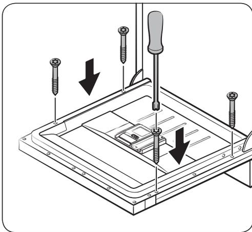
10. Befestigen Sie die Türverkleidung mit den 4 Schrauben (M3,5 X 45) an der Gerätetür.
