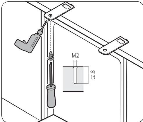
1. Setzen Sie die mitgelieferten Halteklammern in die oberen vorderen Öffnungen der Spülmaschine ein (siehe Abbildung).
