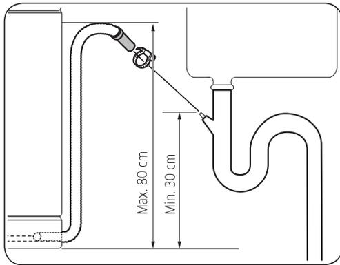
1. Schließen Sie den Abwasserschlauch an den Abwasseranschluss an.
