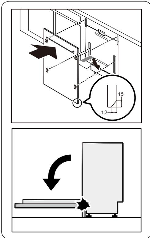
4. Halten Sie die Türverkleidung fest, bringen Sie sie an der Tür an und setzen Sie die Halterungen für die Türverkleidung in die entsprechenden Bohrungen ein.
