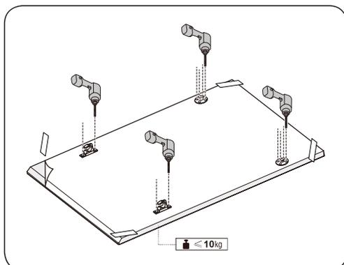
1. Legen Sie die Einbauschablone auf die Rückseite der Türverkleidung und fixieren Sie sie vorübergehend mit durchsichtigem Klebeband. Beachten Sie, dass die Rückseite der Türverkleidung an der Tür der Spülmaschine angebracht wird.
