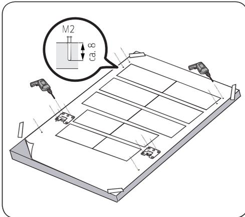
1. Legen Sie die Einbauschablone auf die Rückseite der Türverkleidung und fixieren Sie sie vorübergehend mit durchsichtigem Klebeband. Beachten Sie, dass die Rückseite der Türverkleidung an der Tür der Spülmaschine angebracht wird.
