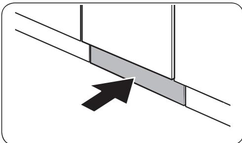
3. Schieben Sie die Sockelleiste mit den Klammern in die Unterseite der Spülmaschine hinein (siehe Abbildung).
