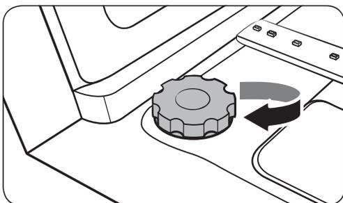
5. Drehen Sie das Anschlussstück zum Schließen im Uhrzeigersinn.
