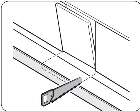
3. Trennen Sie mit einer Säge entlang der Linie ein Teil von der Sockelleiste ab.
