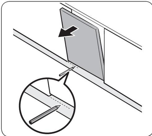
1. Setzen Sie die Sockelleiste an der Unterseite der Spülmaschine ein.
