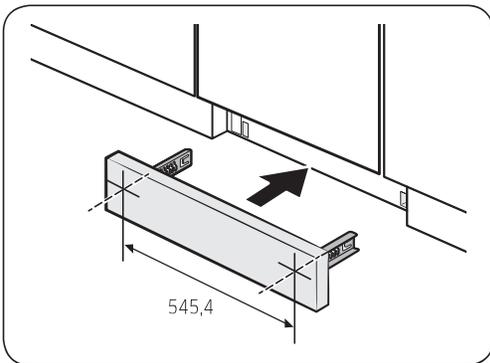
2. Setzen Sie die vorgeschchnittene Sockelleiste zuerst in die Klammern ein und ziehen Sie dann die Schrauben fest, um die Leiste zu befestigen. Betrachten Sie die Abbildung links und stellen Sie sicher, dass die Klammern sich an der richtigen Stelle befinden.
