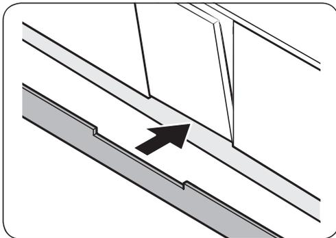
4. Bringen Sie die verkleinerte Sockelleiste an der Unterseite der Spülmaschine an. Stellen Sie sicher, dass die Leiste nicht die Tür der Spülmaschine behindert.
