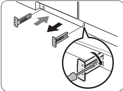
1. Setzen Sie die mitgelieferten Halterungen an der Unterseite der Spülmaschine ein. Drehen Sie sie in die richtige Stellung.
