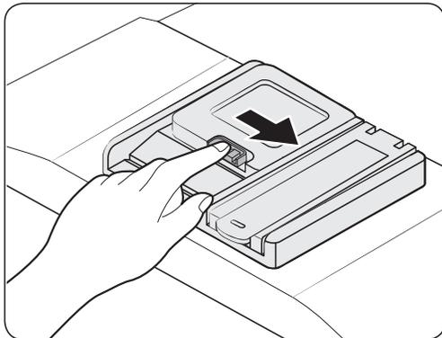
1. Drücken Sie zum Öffnen rechts am Deckel auf die Entriegelung des Spülmittelfachs.
