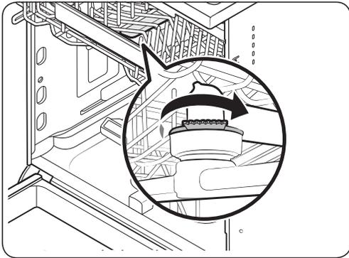
1. Öffnen Sie die Tür, und ziehen Sie dann den Oberkorb heraus, um an den oberen Sprüharm zu gelangen.
