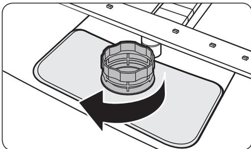
4. Beseitigen Sie Schmutz und Verunreinigungen aus dem Mikrofilter und den Grobfilter.
