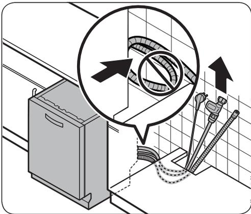
3. Ziehen Sie den Netzstecker, den Frischwasserschlauch und den Abwasserschlauch durch die Öffnung unter dem Waschbecken.
